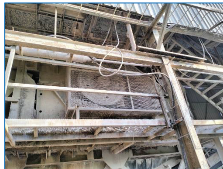
รูปที่ 2-42: การจัดส่วนปิดหรือแผ่นกัน (Guard) สำหรับเครื่องจักรกล
